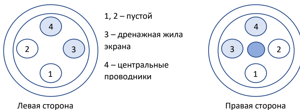
Рисунок А.4 – Подключение жил кабелей к колодке коммутационной
